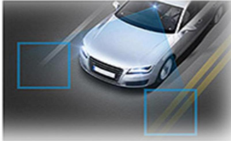
1. 주차 시 차량에 설치된 블랙박스는 카메라를 동작시켜 주변 감시를 진행하게 된다. 이러한 경우 지속적으로 블랙박스가 동작하여 자동차 배터리를 소모하여 차량 시동이 걸리지 않은 문제가 발생하거나 블랙박스가 저전압을 감지하여 중도에 동작을 중지하는 현상이 발생한다.
